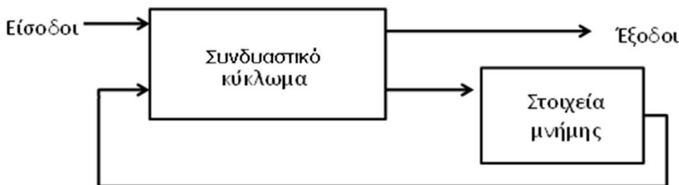
Εικόνα 3.1: Σχηματική διάταξη ακολουθιακού κυκλώματος
