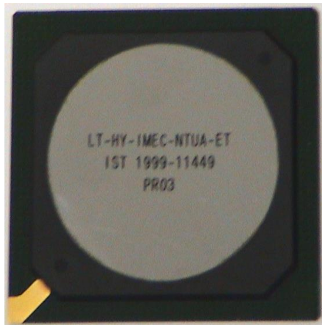
Εικόνα 1.26: Παράδειγμα chip μετά την κατασκευή στο εργοστάσιο (fabrication, packaging)
