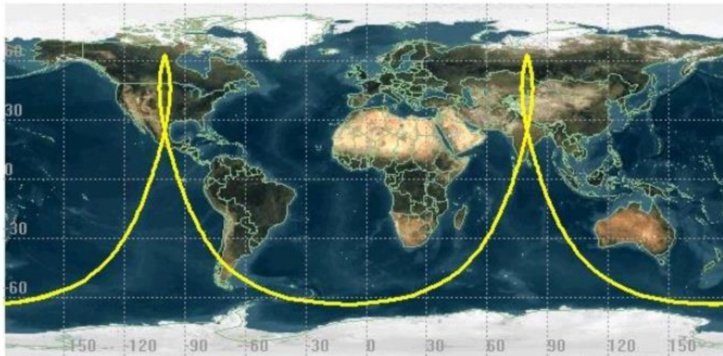
Σχήμα 2.33 Παράδειγμα ίχνους της τροχιάς Molniya για \omega=270^\circ και εκκεντρότητα 0,75 (Πηγή: Wikipedia )
