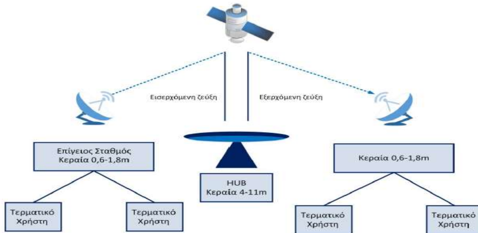
Σχήμα 11.3 Συνδεσιμότητα τερματικών χρηστών και ενός Hub ως αναμεταδότη μέσω τοπολογίας αστέρα
